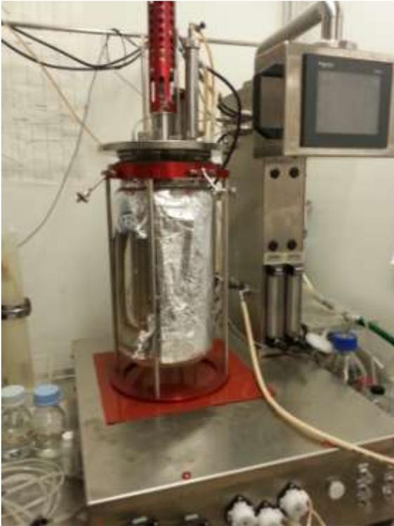
Esempio di reattore automatizzato (**alternativa 1**)
