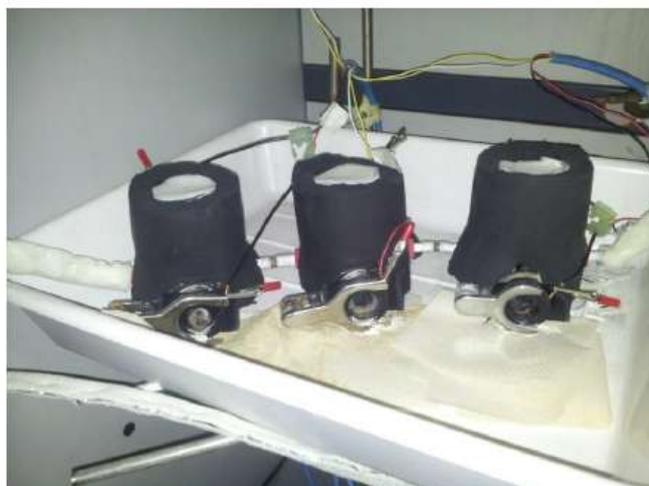
Fig 3.4.1. Schema e fotografia delle MFC impiegate
