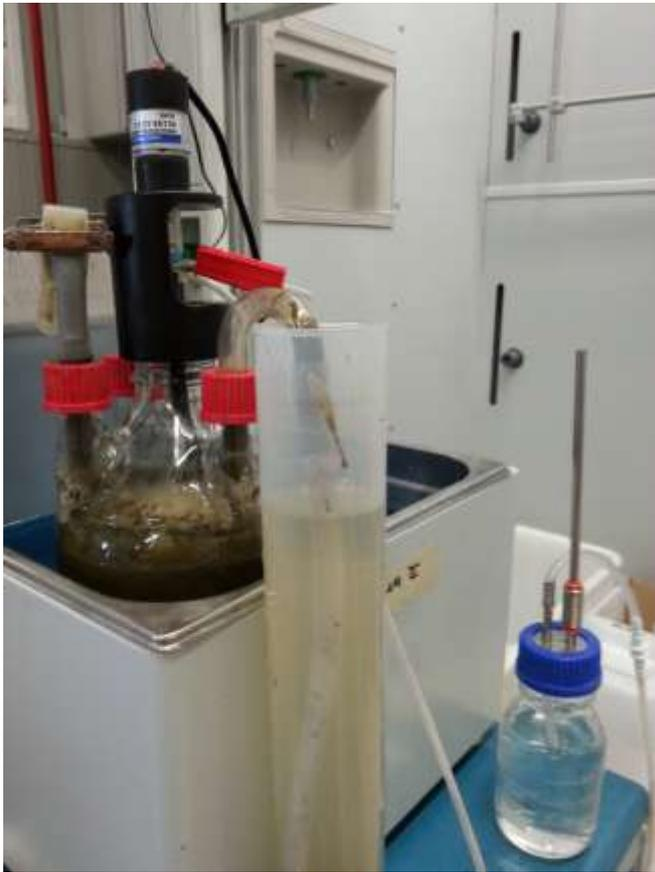
9. **Attendere** alcune ore (almeno 3 o 4) per consentire un certo accumulo di biogas o, in alternativa, avviare il reattore il giorno precedente con solo inoculo e dosare i substrati frullati con la siringa dalla bocca di alimentazione.
