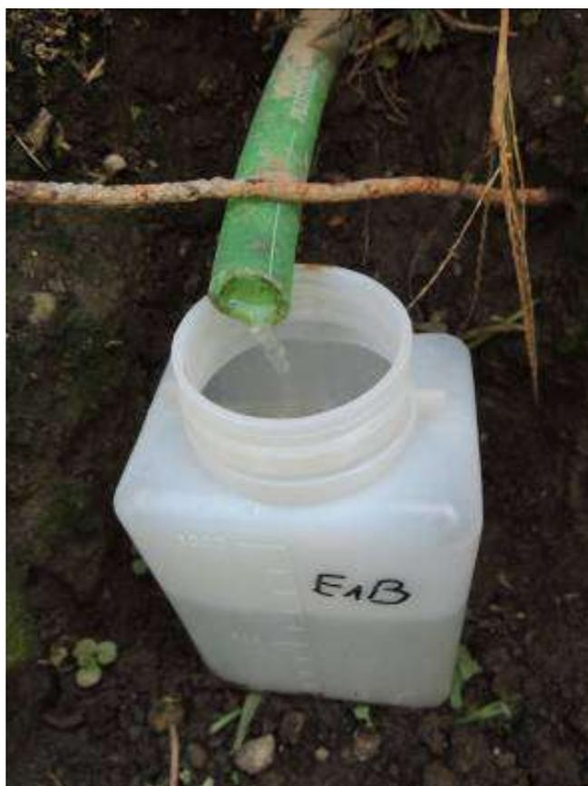
*Figura 2.3.6 – Particolare del tubo in uscita di una delle due vasche a flusso sommerso verticale.*
