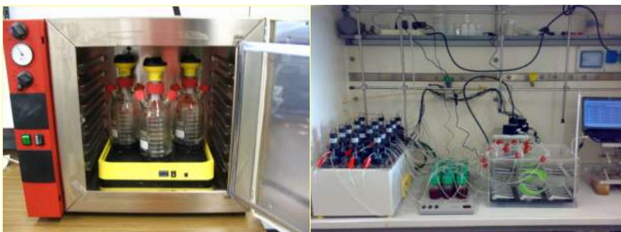
*Fig 2.2.4a – Sistemi per la misura del BMP di diversi campioni in parallelo con metodo manometrico (sx) e volumetrico (dx).*
