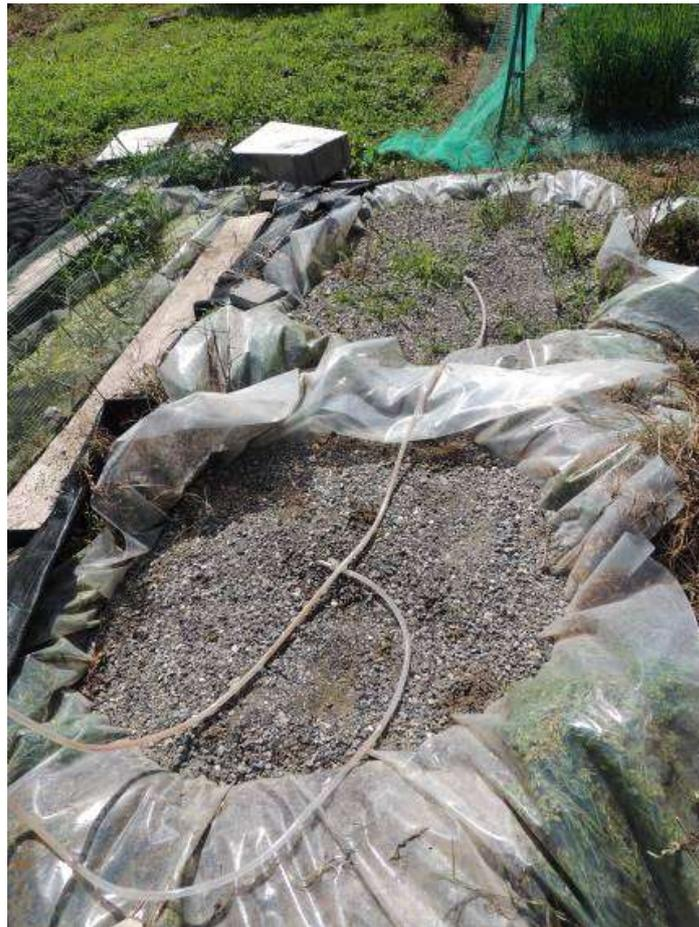
*Figura 2.3.5 – Le due vasche a flusso sommerso verticale: in primo piano la vasca di controllo senza vegetazione ed in secondo piano quella con la canna di palude.*
